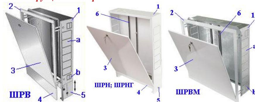
Детали шкафов выполнены из оцинкованной стали. Лицевые поверхности окрашены порошковой эмалью RAL9016 по фосфатной подготовке. В боковых стенках корпуса 1 выполнена перфорация «а», сегменты которой удаляются в месте, удобном для пропуска соединительных трубопроводов. Выдвижная рамка встраиваемых шкафов позволяет регулировать глубину от 125мм до 195 мм. Выдвижные ножки 5 дают возможность регулировать высоту шкафа от 670 мм до 760 мм. Ножки 5 имеют отверстия для крепления шкафа
